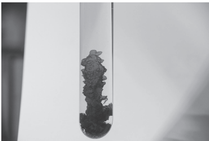
(写真1) トラウベの実験の追試験の様子。硫酸銅水溶液を満たした試験管にヘキサシアノ鉄(II) 酸カリウムの結晶粒1個を加えてから10分後。 撮影：小玉直子。
