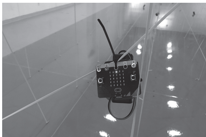
図4 micro:bitを使った振動を感知するセンサー
