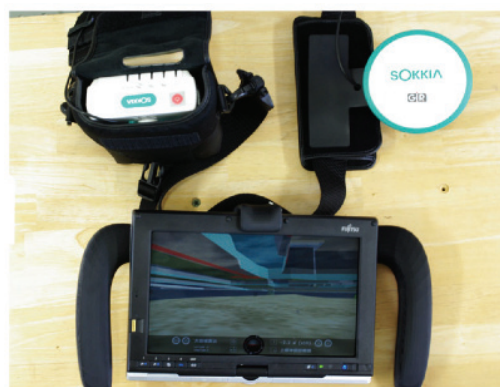
図 3 MBAS(SOKIA-GR1600)と AR 表示システム
